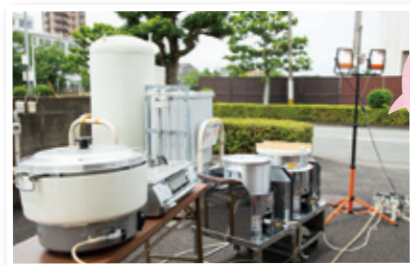
煮炊き釜やガスコンロなどを備えた災害対応型LPガスバルク供給システム。
